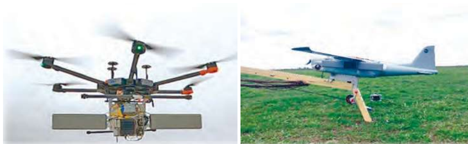
Рис. 2. Вариант размещения РЛС на БПЛА мультикоптерного и самолетного типа
